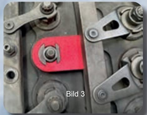
2. In einem AOG-Ereignis fehlte ein spezielles Gegenhalte-Tool für den Tausch eines Engine Washers; durch Vermessung und zwei kurzen Iterationen stand noch am selben Tag ein funktionsfähiges Hilfsmittel bereit – die Arbeit wurde abgeschlossen und das Flugzeug früher als geplant freigegeben (Abb. 3).
